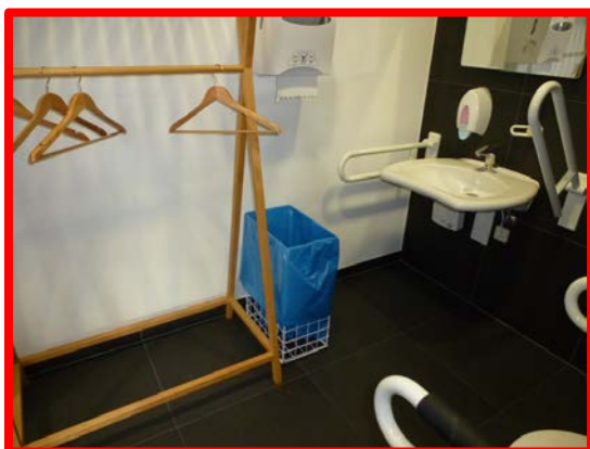
Abbildung 19: links - Standort Leipziger Straße, Bewegungsfläche im Sanitärraum nicht ausreichend / rechts - Campus Altonaer Straße, Haus 8, Bewegungsfläche im Sanitärraum ausreichend
